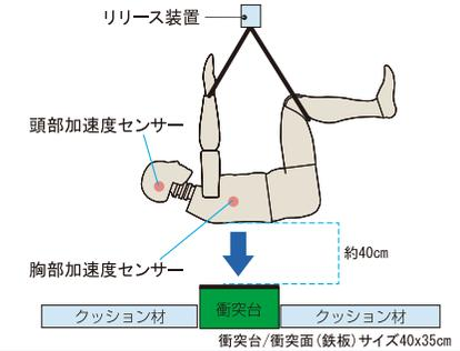
2. ダミー落下時の背面部保護性能評価試験
